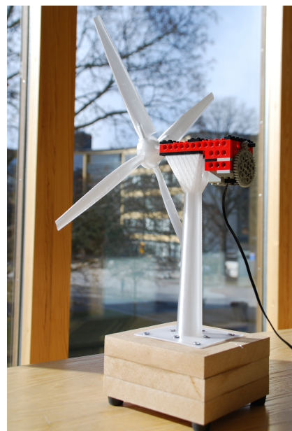
Figur 4.2: Färdigt vindkraftverk med fyra vridna vingar
