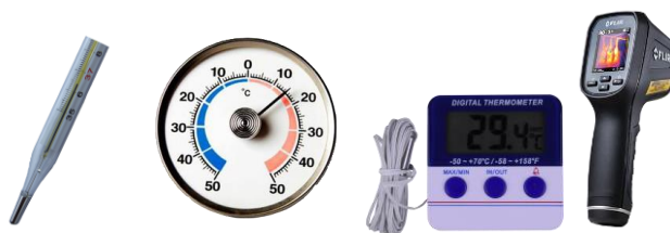
Figur 1: Fyra olika termometrar som alla mäter temperaturen på olika sätt.
