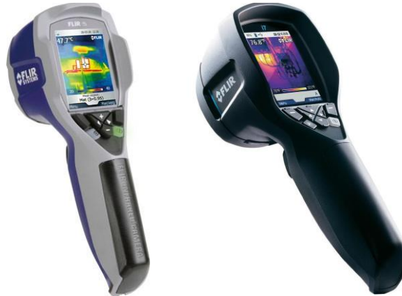
Figur 3.5: Handhållna värmekameror av modellerna i5 och i7 som användes under besöket.
